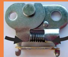
Comprimer le ressort et mettre le fusible en place
