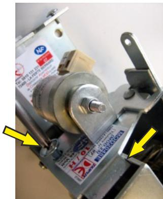
Oter le bouchon et mettre en place le passe câble.
