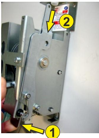
Mettre en place la bobine en partie supérieur du treuil. Vérifier l'embôtement de la platine dans le carter. Utiliser la vis fournie.
